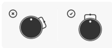
Alinea el indicador redondo del módulo con el interruptor del tarro de cristal para que funcione.
