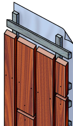
Tekening 4 Verticale open gevelbekleding op dubbel regelwerk.
