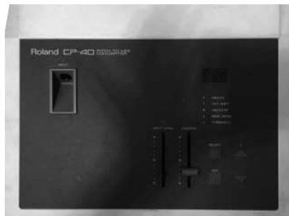
חלק מהציוד האלקטרוני ששימש לכתבת משפט קסטנר - מכשיר שמזהה גובה צליל של סיגנל ומתרגם אותו לערך MIDI 9
