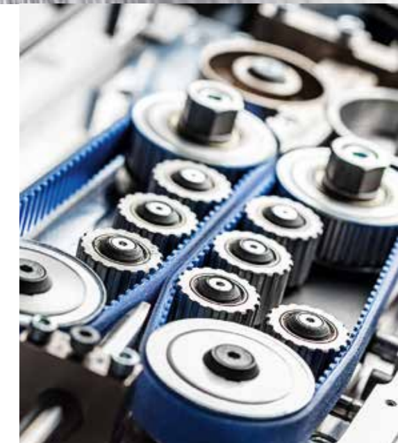
高效皮带驱动将可靠地以 9 m/s 的速度引入电缆。
