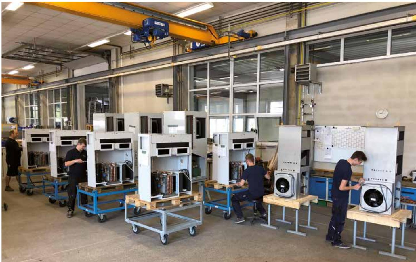
На главном заводе в Амтцеле (в Германии) разрабатывается, конструируется и производится вся продукция фирмы FrigorTec GmbH. Перед поставкой каждая установка проходит контроль качества с тестовым прогоном. Благодаря всемирной дистрибьюторской сети мы поставляем продукцию FrigorTec в более чем 100 стран.
