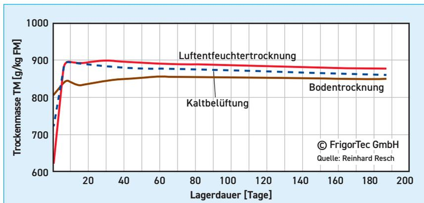
3 Einfluss unterschiedlicher Trocknungsverfahren auf den Trockenmassegehalt TM (2)
