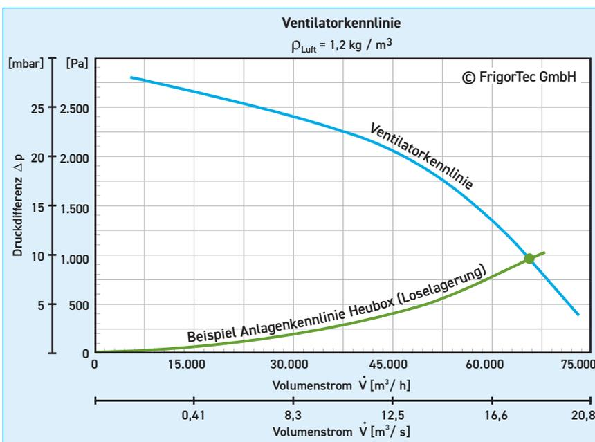
20 Kennlinie eines AGRIFRIGOR™-Ventilators
