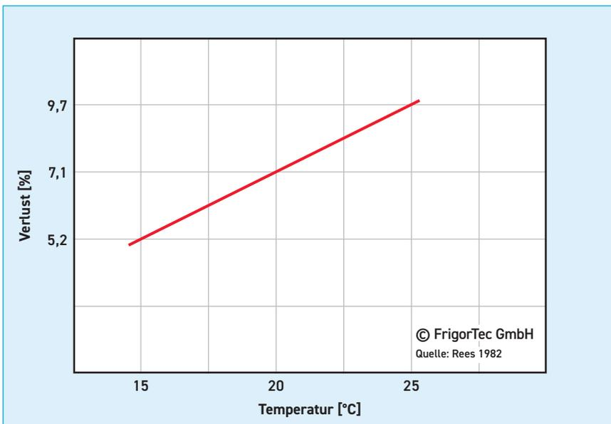
26 Atmungsverluste bei Bodentrocknung
