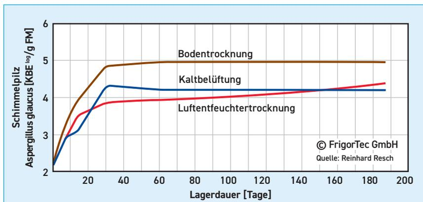
4 Unterschied verschiedener Trocknungsverfahren auf die Entwicklung des Schimmelpilzes *Aspergillus glaucus* (2)
