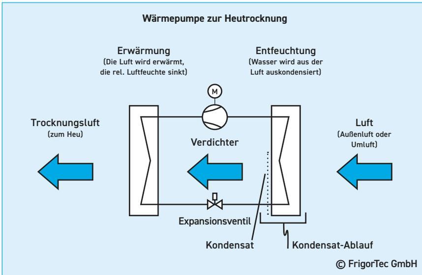
12 Verfahren der Wärmepumpe zur Luftentfeuchtung
