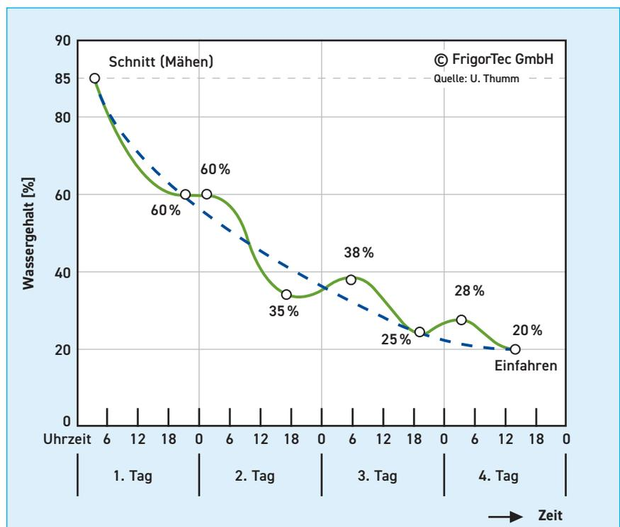
1 Feuchteverlauf bei Bodentrocknung von Heu
