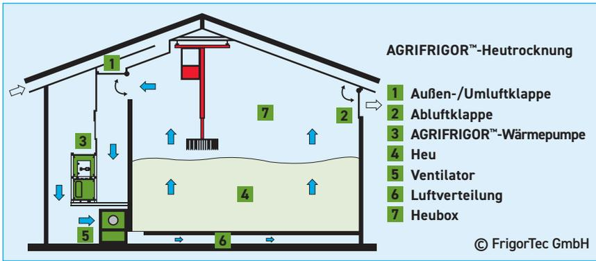
11 AGRIFRIGOR™-Verfahren zur Heutrocknung mittels Wärmepumpe bzw. Entfeuchter
