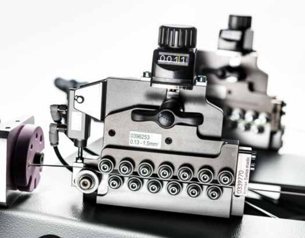
气动矫直机，带线径显示，推荐用于：0.13-1.5 mm 2 。
