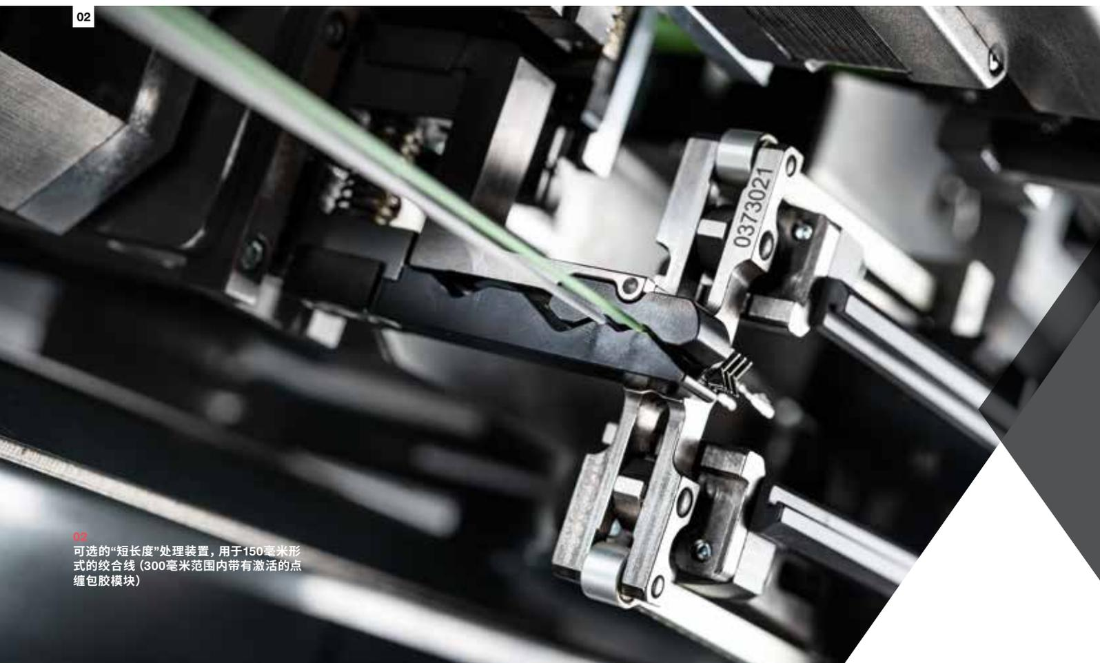
02 可选的“短长度”处理装置, 用于150毫米形式的绞合线 (300毫米范围内带有激活的点缠包胶模块)
