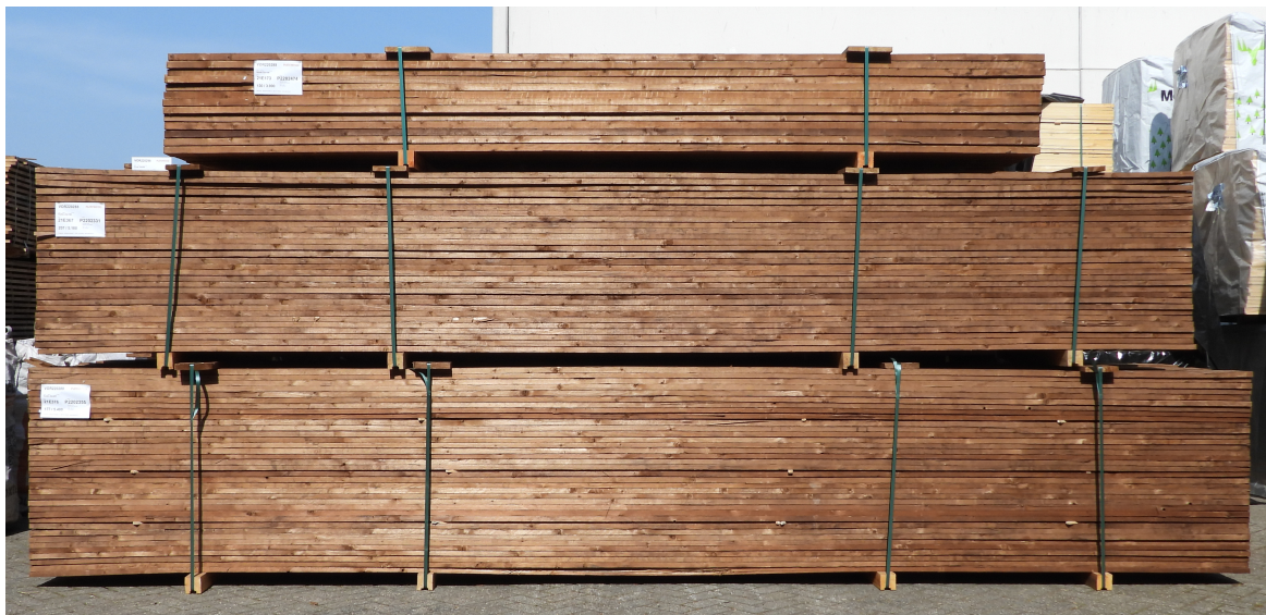
Afbeelding 1 – Onbehandeld hout op de juiste wijze opslaan
