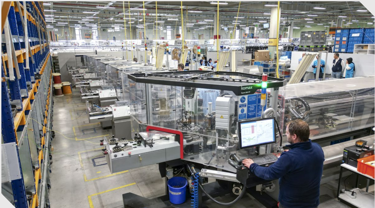
Der grösste Produktionsstandort «Fabrik 1» von Nursan in Tavşanlı, Istanbul, Türkei, stellt pro Jahr Kabelsätze für bis zu 750 000 Fahrzeuge her. Dabei kommen u. a. Sigma 688 Verdrillmaschinen sowie Crimp-to-Crimp-Maschinen der Alpha-Serie von Komax und CrimpCenter von Schleuniger zum Einsatz.
