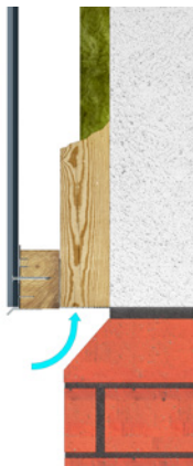
De onderzijde van het buitenhoekprofiel moet gelijk gemonteerd worden met de onderzijde van het sokkelprofiel
