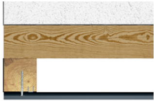
Montage van de platen, gelijk met het vensterkozijn.
