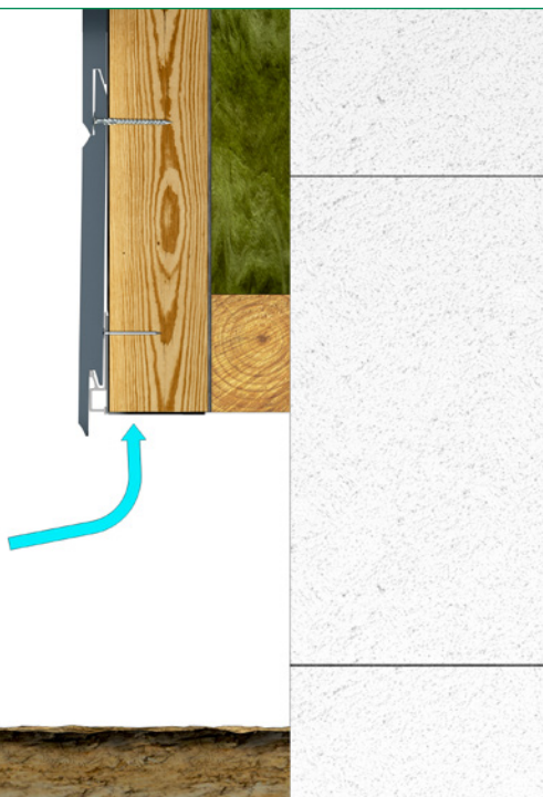
Bevestiging van het ventilatieprofiel.
