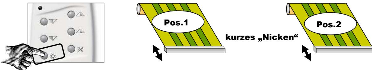
Durch ein kurzes „Nicken“ (**5cm auf und 5cm ab**) bestätigt die Markise(n), dass sie nun auf die Funkbefehle der Steuerung reagiert (reagieren).
