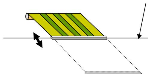
Bei Erreichen der gewünschten Zwischenposition den AUF- Taster des Handsenders drücken und solange gedrückt halten, bis der Motor bestätigt (Nach ca. 5 Sekunden). Die Bestätigung erfolgt durch ein kurzes „Nicken“ (5cm auf und 5cm ab).
