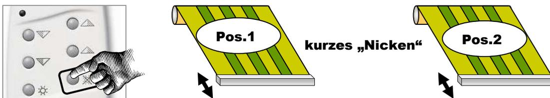
Durch ein kurzes „Nicken“ (**5cm auf und 5cm ab**) bestätigt die Markise, dass sie nun **nicht** mehr auf die Funkbefehle der Steuerung reagiert.
