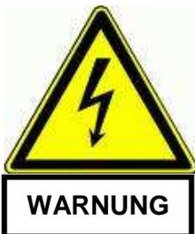
Der Begriff **WARNUNG vor gefährlicher elektrischer Spannung** wird bei Warnung vor unmittelbar drohenden Gefahr bei berühren der Spannungsführenden Teilen verwendet. Die möglichen Folgen können Tod oder schwerste Verletzungen sein (Schäden an Personen).
