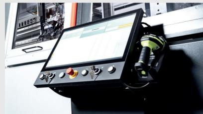
Optional kann an der Maschinenfront ein verfahrbarer und neigbarer Monitor angebracht werden. Dieser lässt sich manuell auf der gesamten Prozessebene verschieben.
