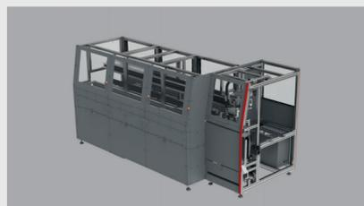
Neben der Variante der Gutteilrutsche kann optional ein Ablagesystem konfiguriert werden, welches die Schlechtteile von den Gutteilen separiert und in Batches ablegt. Die produzierten Leitungen können dann per Hand aus der Maschine entnommen werden. Die Entnahme für Gutleitungen kann von vorne oder hinten erfolgen.
