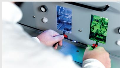
Bei der Option Handeinlage kann zwischen einseitiger sowie beidseitiger Einlage ausgewählt werden. Zudem besteht die Möglichkeit, die Leitungen bereits vorkonfektioniert in die Maschine einzulegen.
