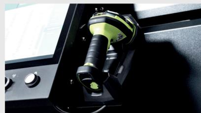
Zum Einlesen von Batches oder Verbrauchsmaterialien besteht die Option eines Barcode Scanners.
