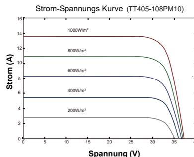
\* Die Spezifikationen wurden unter den Standardtestbedingungen (STC) gemessen: 1000 W/m<sup>2</sup> Sonneneinstrahlung, 1,5 Luftmasse und 25°C Zelltemperatur. Die Messunsicherheit für alle Panels beträgt 6%. Die tatsächlichen Parameter unterliegen den individuellen Verträgen. Diese Parameter dienen nur als Referenz und sind nicht Bestandteil der Verträge. Die technischen Spezifikationen in diesem Dokument können variieren. Weitere Informationen finden Sie in der "Installationsanleitung".
