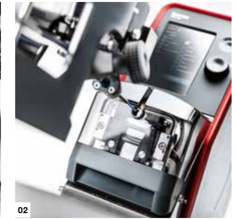
01 Platzsparende Integration – der Schwenkarm der CC-Maschine kann problemlos auf die Mira zugreifen. 02 Volle Mira-Funktionalität in einer Komax Crimp-to-Crimp Maschine.
