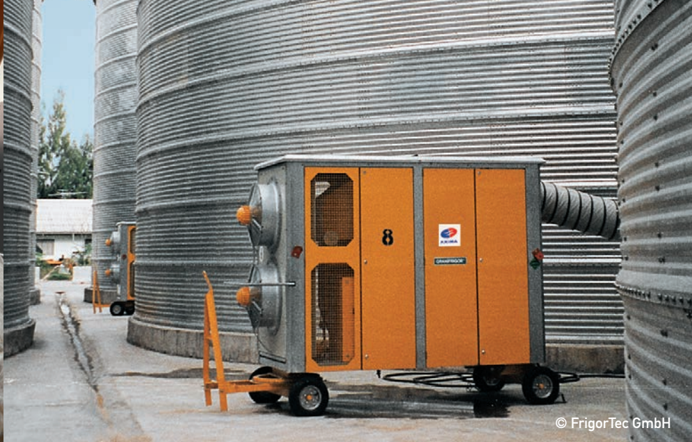
1 GRANIFRIGOR™ zur Kühlung von Getreide-Stahlsilos
