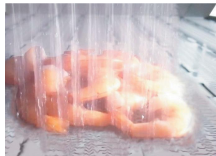
Figura 8. Esquerda: cozedor de camarões por jatos de água e camarões durante o cozimento (Innotec Systems BV, Holanda)
