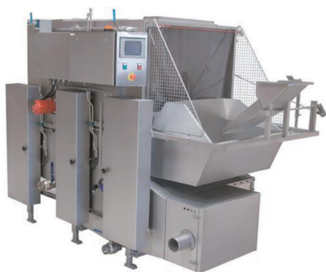
Figura 6. Esquerda: cozedor de camarões por imersão automática por batelada (Carsoe, Dinamarca). Direita: cozedor a vapor por convecção (Laitram Machinery, EUA).
