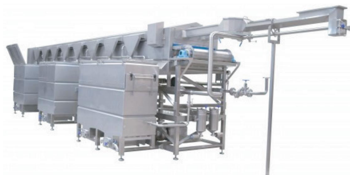
Figura 8. Esquerda: cozedor de camarões por jatos de água e camarões durante o cozimento (Innotec Systems BV, Holanda)
