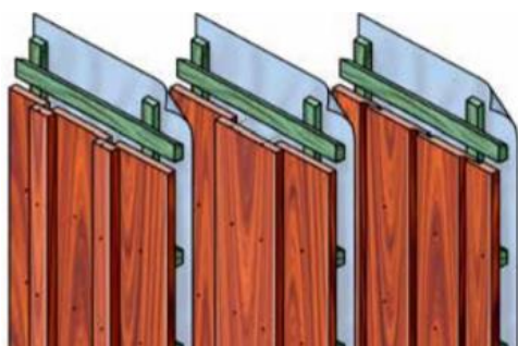
Afbeelding 4 - Verticale gevelbekleding V.l.n.r. opdekwerk, opdekwerk en rabat met halfhoutse overlap (channelsiding). (Bron: Centrum Hout, 2018)
