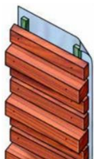
Afbeelding 3 - Horizontale open gevelbekleding met variabele afmetingen, trapeziumvormig voor goede afwatering. (Bron: Centrum Hout, 2018)
