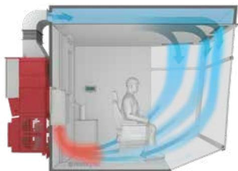
Рис 2 Принцип работы кранового кондиционера серии V
