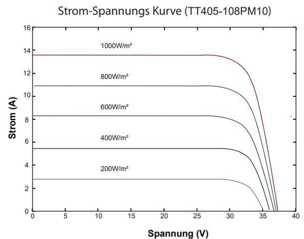
\* Die Spezifikationen wurden unter den Standardtestbedingungen (STC) gemessen: 1000 W/m<sup>2</sup> Sonneneinstrahlung, 1,5 Luftmasse und 25°C Zelltemperatur. Die Messunsicherheit für alle Panels beträgt 6%. Die tatsächlichen Parameter unterliegen den individuellen Verträgen. Diese Parameter dienen nur als Referenz und sind nicht Bestandteil der Verträge. Die technischen Spezifikationen in diesem Dokument können variieren. Weitere Informationen finden Sie in der "Installationsanleitung".
