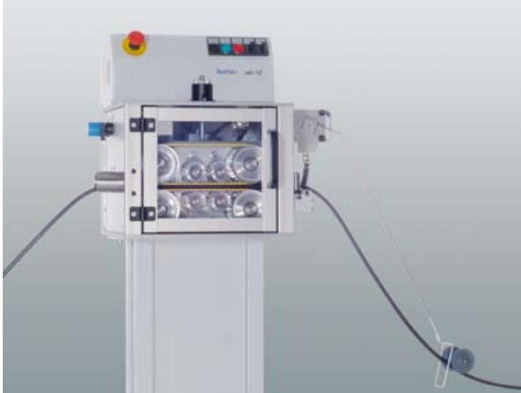
Machine de traction ads 112 avec bras de réglage
