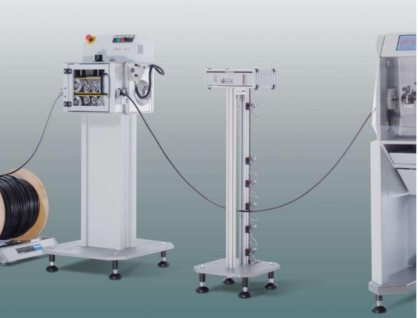
Machine de traction ads 112 avec commande de la flèche DHS 1000 D sur Kappa 350
