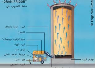
إن التدفئة الذاتية للحبوب تُسبب غالباً ضرراً كبيراً. إن إن مروحة مُبرد الحبوب ™GRANIFRIGOR تشفط الهواء المحيط (انظر لوائح القوانين الصحية الصارمة والتوجه نحو معالجة طبيعية للحبوب الغذائية الصورة أدناه). يتم تبريد هذا الهواء في المُبرد (المُبخر) إلى درجة الحرارة دون استخدام المواد الكيميائية هي مطالب يجب الإيفاء بها. وللإستجابة لكل هذه التحديات، لدينا جواب واحد وهو ™GRANIFRIGOR
