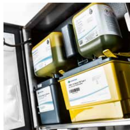
▶ 用于喷墨的墨盒以及i-Tech过滤模块*——都带有RFID检查
