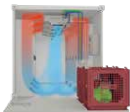
Abb. 1 Verfahrensprinzip zur Containerkühlung
