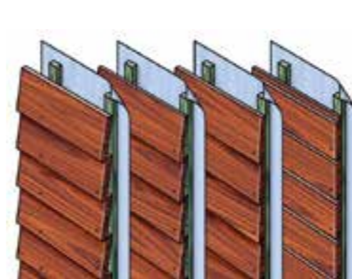
Tekening 1 Horizontale gevelbekleding. V.l.n.r. potdekselwerk, Bevelsiding, Zweeds rabat en halfhouts rabat.
