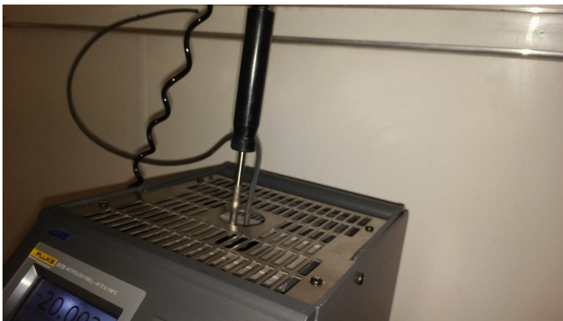
Obr. 4 Snímač umístěn do kalibrační pícky.
