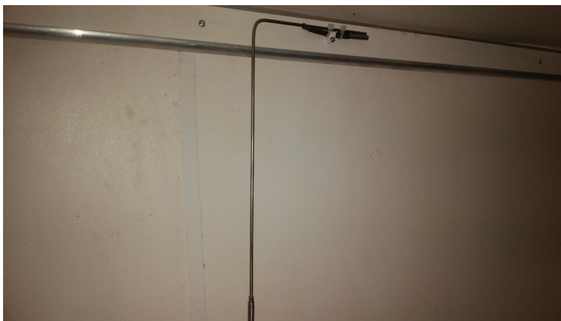
Obr. 6 Umístění etalonového snímače do bezprostřední blízkosti kalibrovaného snímače
