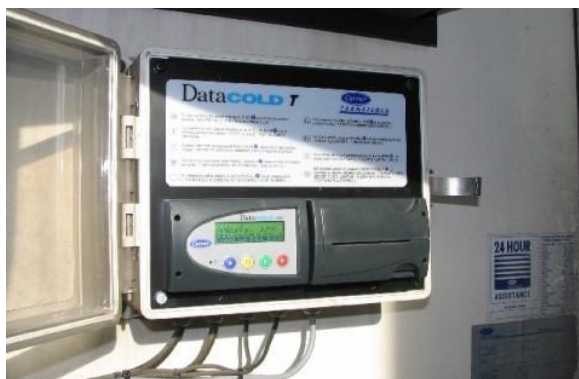
Obr. 3 Záznamové zařízení vyhodnocovací jednotka umístěna mimo chlazený prostor.
