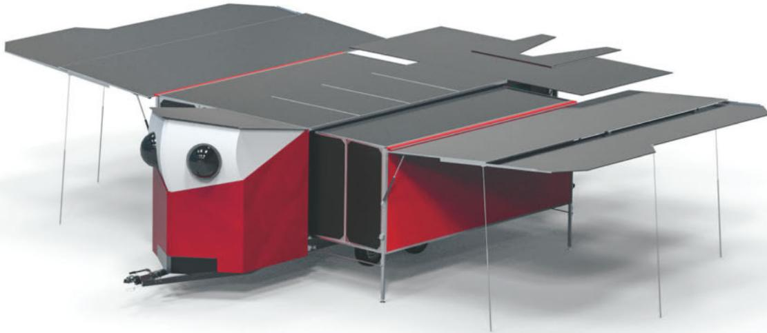
Die Panels des Solar Butterfly ermöglichen eine Produktion von bis zu 170 kWh Solarstrom pro Tag, womit täglich bis zu 300 km zurückgelegt werden können.
