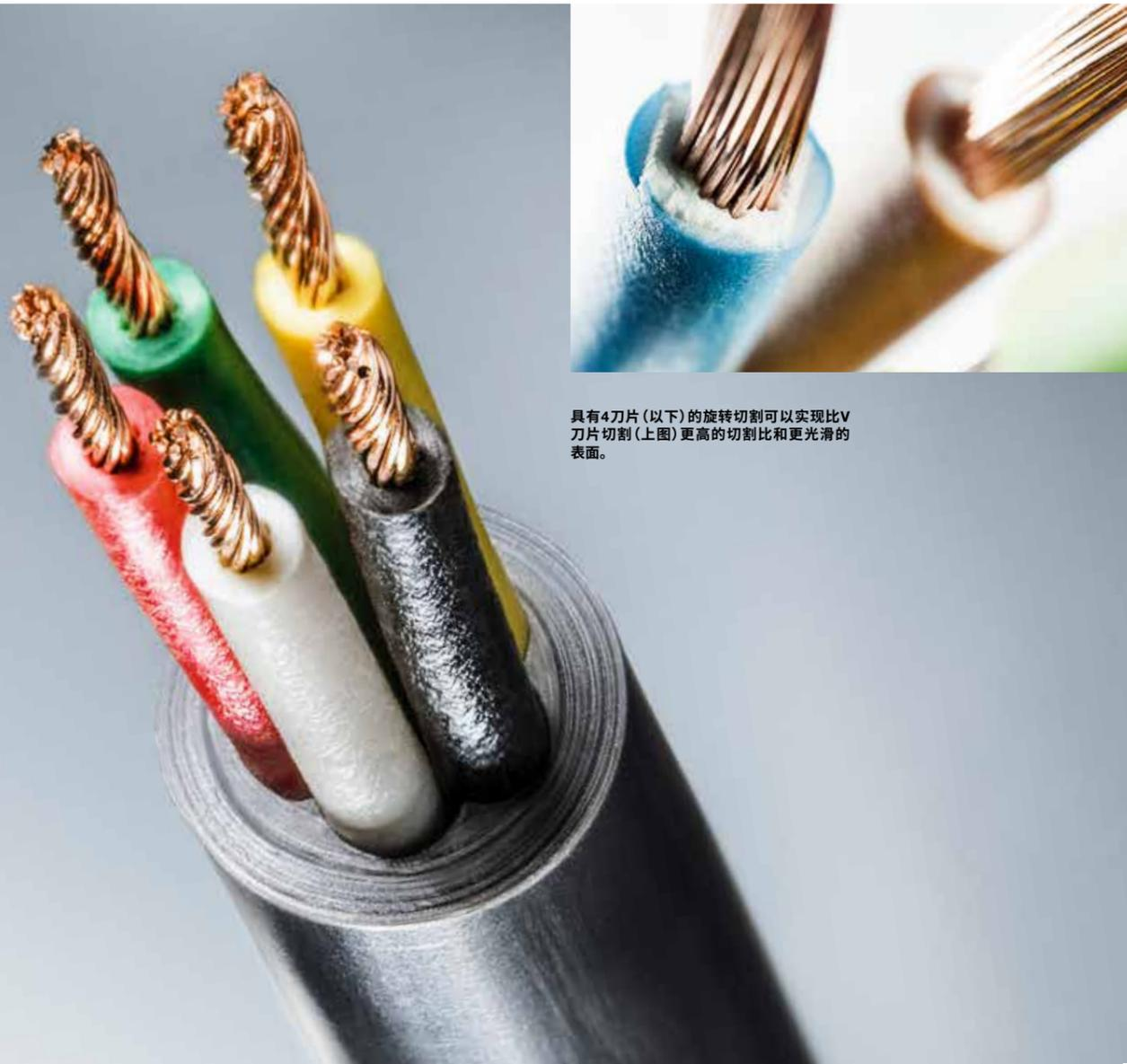
具有4刀片(以下)的旋转切割可以实现比V刀片切割(上图)更高的切割比和更光滑的表面。
