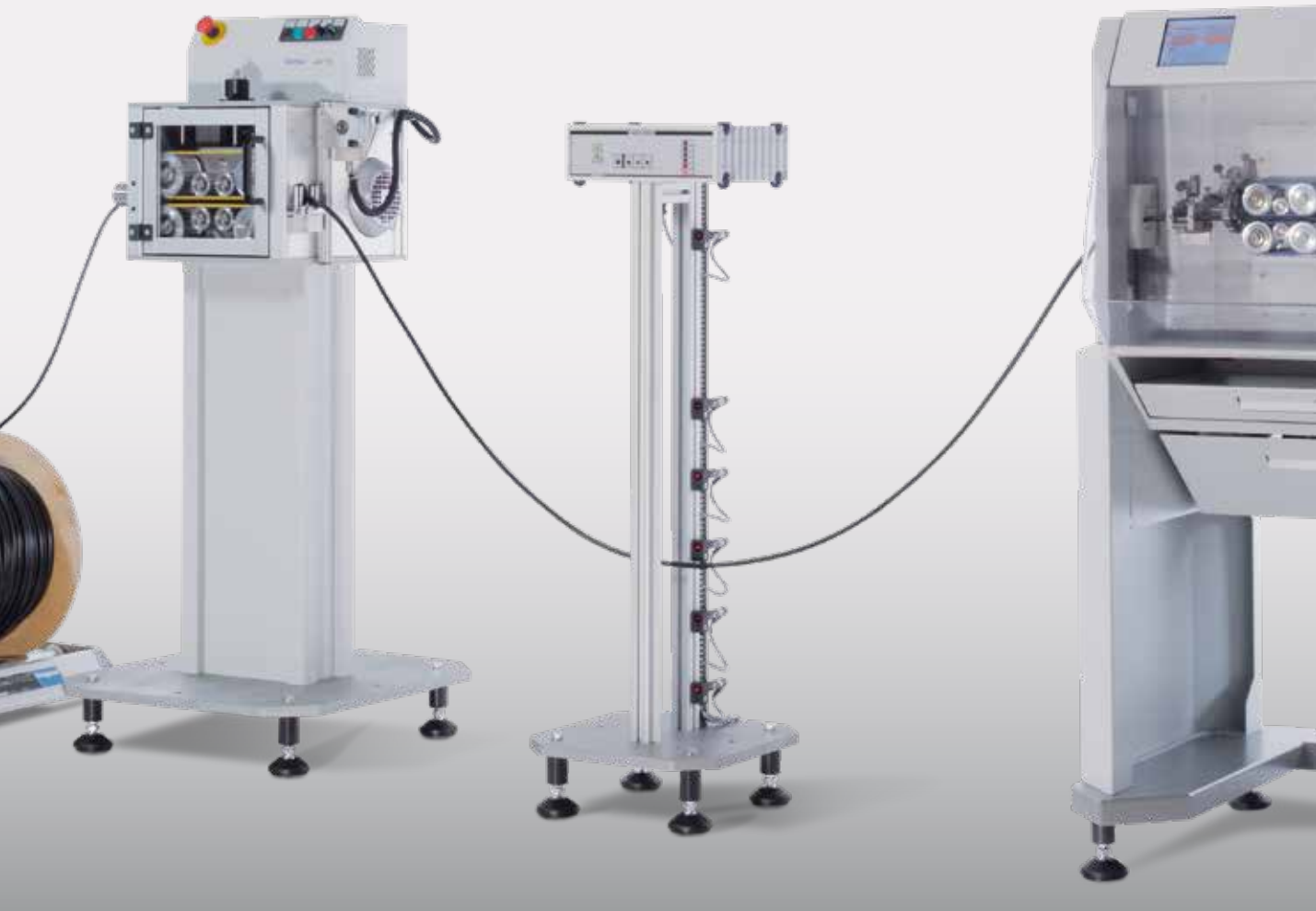
▲ ads 112 Zugmaschine mit Durchhangsteuerung DHS 1000 D an Kappa 350
