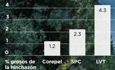
Resistencia al agua probada: El test de hinchazón en los bordes (ISO 24336: 2005) revela lo que les sucede a los suelos cuando se sumergen en agua. Corepel marca una diferencia real: mientras que otros suelos con propiedades impermeables se hinchan, Corepel demuestra ser la mejor opción en estos entornos difíciles.
